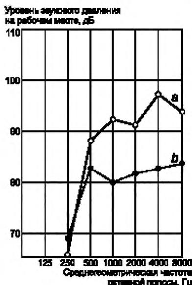
а — твердый шлифовальный круг, уровень звука  $L_{pA} = 100$  дБА, б — шлифовальный круг со связанным абразивом, уровень звука  $L_{pA} = 89$  дБА
