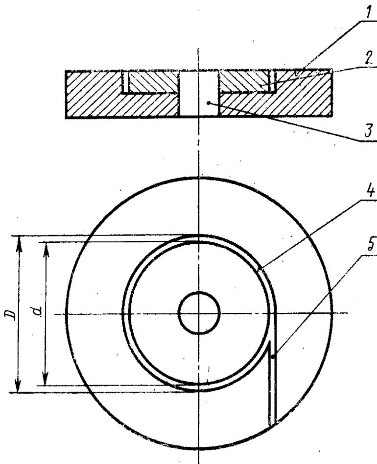
б) держатель для образцов (см. чертеж), состоящий из корпуса 1 с цилиндрической выточкой диаметром  $D=49,3\pm 0,05$  мм и набора сменных дисков 2. Глубина выточки и высота дисков должны быть равны 7,5 мм.
