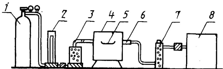
грев до 1400 °С; лодочки фарфоровой № 2 по ГОСТ 9147—80, прокаленной при 1300 °С в токе кислорода 5; трубки фарфоровой с внутренним диаметром 20—22 мм, длиной 650—750 мм 6; сосуда-поглотителя 7, диаметром 25 мм и высотой 150 мм с отрезками для подвода резиновых трубок, заполненного влажной анионитной смолой ЭДЭ-10П.
