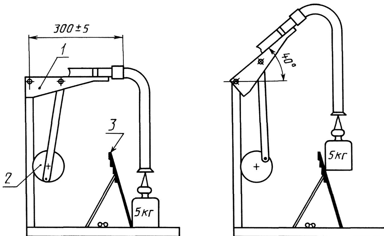
1 — качающийся рычаг; 2 — кривошипный механизм; 3 — наклонная плоскость
