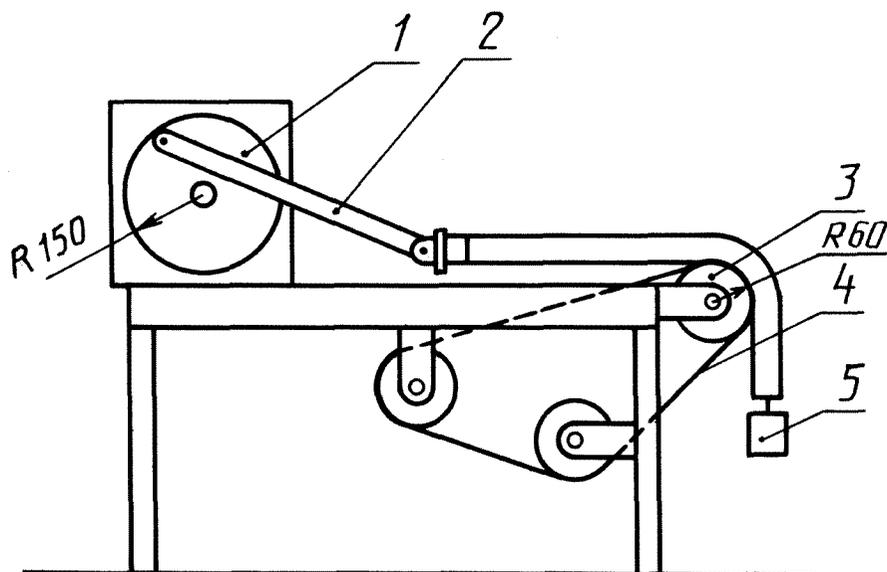
1 — кривошипный механизм; 2 — соединительный стержень; 3 — ролик; 4 — ремень из абразивной ленты;
