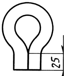
Рисунок 103 — Конфигурация шланга для испытания его холодом (22.102)
