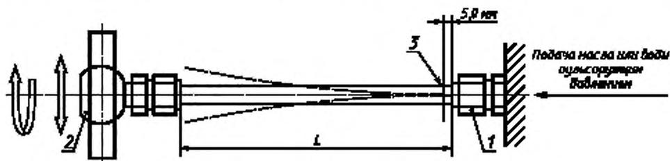
1 — испытуемый образец; 2 — движущийся конец; 3 — место установки тензодатчика
