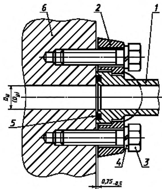
1 — nipple; 2 — два разъемных полуфланца; 3 — болт; 4 — пружинная шайба; 5 — резиновое кольцо; 6 — корпус (гнездо)
