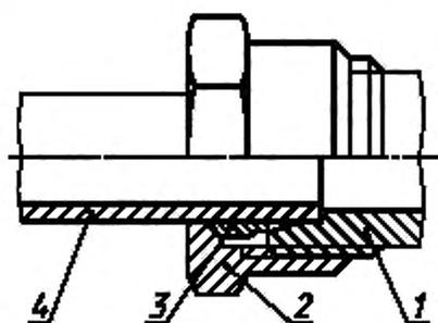
1 — присоединительный конец корпусной детали исполнения 1 по ГОСТ 22525; 2 — накидная гайка по ГОСТ 23353; 3 — врезавшееся кольцо по ГОСТ 23354; 4 — труба
