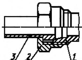
1 — присоединительный конец корпусной детали исполнения 1 по ГОСТ 22525; 2 — накидная гайка по ГОСТ 23353;
