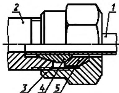
1 — труба; 2 — присоединительный конец корпусной детали исполнения 1 по ГОСТ 22525; 3 — накидная гайка по ГОСТ 23353,
