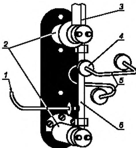
1 — впуск топлива; 2 — охлаждающие шины; 3 — термопара; 4 — испытательный фильтр; 5 — выпуск топлива;
