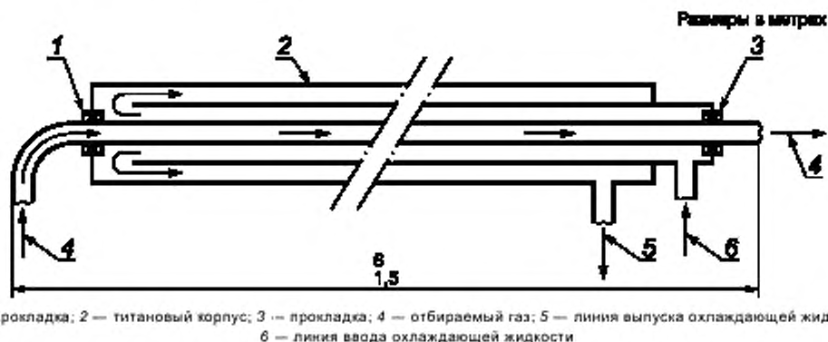
Рисунок В.8 — Пример охлаждаемого зонда
