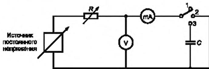
Рисунок 1 — Испытательная установка для выдержки при постоянном напряжении
