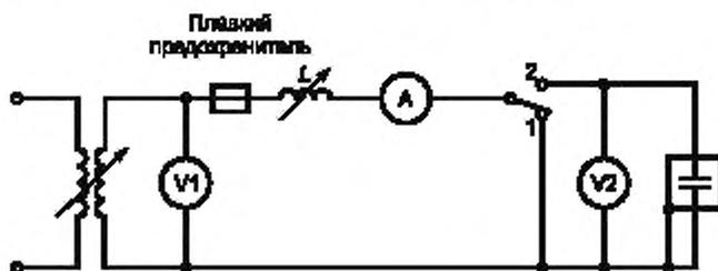
Рисунок 2 — Испытательная установка для разрушающего испытания переменным напряжением
