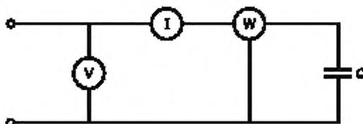
V — вольтметр; I — амперметр; W — ваттметр для работы точно при  $\cos \varphi = 0,1$ ; C — испытуемый конденсатор
