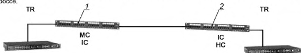
Рисунок 27 — Модель «постоянной линии» магистральной кабельной подсистемы (внешней или внутренней) с двумя точками коммутации
