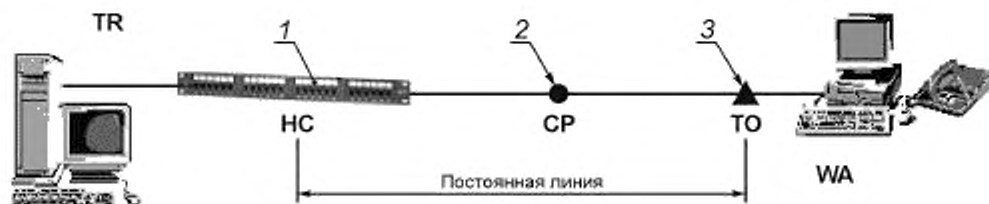
1 — коннектор второй единицы коммутационного оборудования в горизонтальном кроссе (HC); 2 — коннектор консолидационной точки (CP); 3 — коннектор телекоммуникационной или многопользовательской розетки (TO или MuTOA) Рисунок 15 — Модель постоянной линии горизонтальной кабельной подсистемы с тремя точками коммутации
