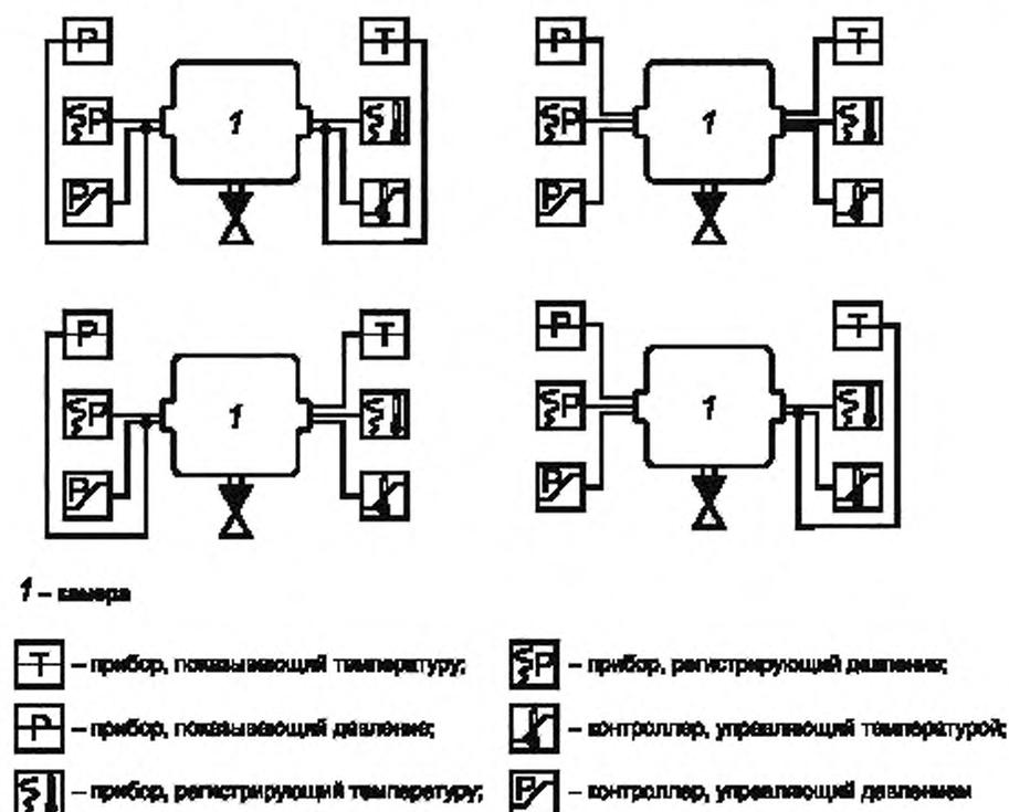
Рисунок 3 — Схемы организации подключения датчиков температуры и давления
