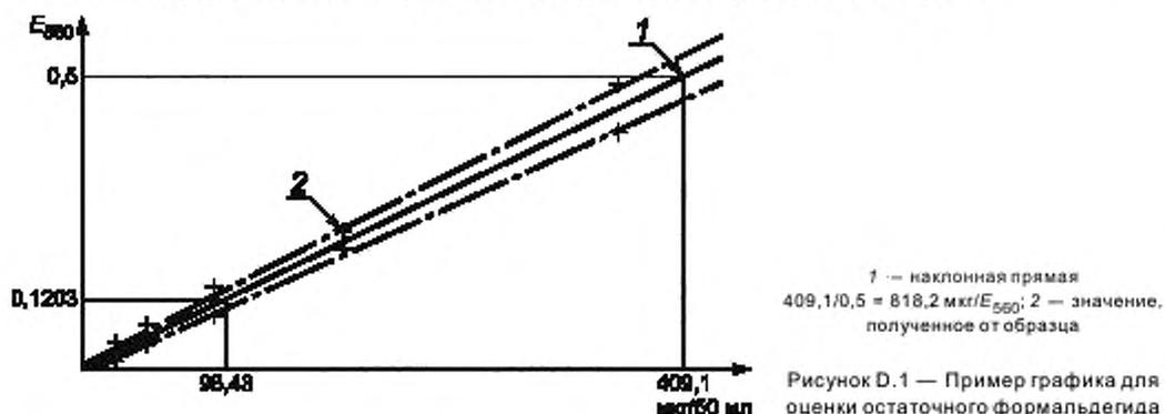
**Пример** — Наклон прямой линии, полученной в ходе процедуры калибровки по D.2.4.2, составляет  $818,2$  мкг/ $E_{560}$ , как показано на рисунке D.1. При измерении экстракта из индикатора, как описано в D.2.2, показания спектрофотометра составляют  $E_{560} = 0,1203$ . Количество остаточного формальдегида в индикаторе может быть считано с диаграммы или рассчитано как  $818,2 \cdot 0,1203 = 98,43$  мкг формальдегида.
