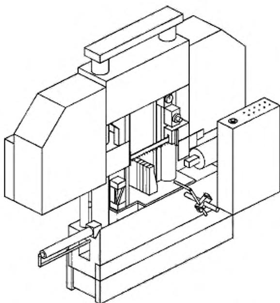
Рисунок С.3 — Горизонтальный ленточно-пильный станок колонного типа
