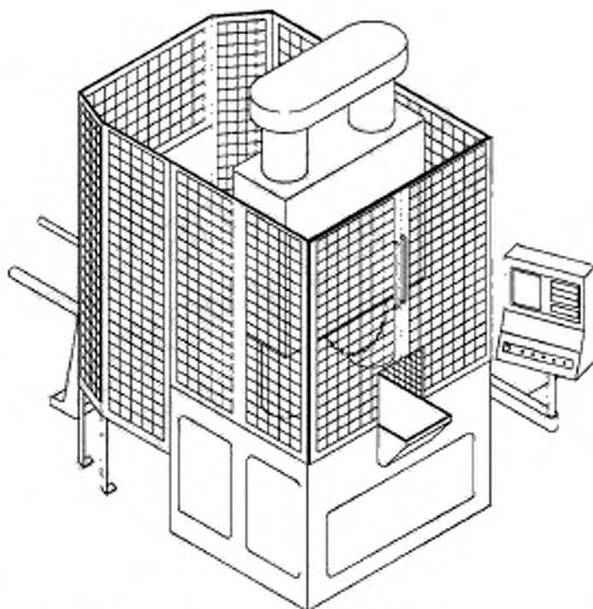
Неподвижные и самозакрывающиеся шарнирные ограждения, включающие регулируемое ограждение места выгрузки отрезанных заготовок.
