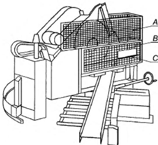
A — стационарное ограждение, смонтированное на (шарнирной) режущей головке над верхней половиной режущего диска,
