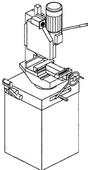
Самозакрывающееся ограждение, когда инструментальная бабка опускается, ограждение касается верха заготовки.
