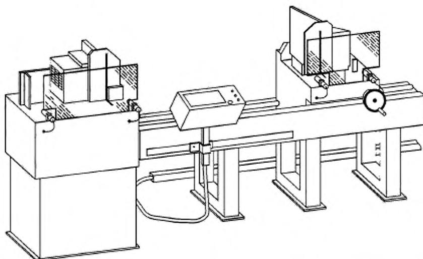
Дисковые отрезные инструменты, перемещенные назад, ограждены неподвижным и перемещаемым ограждением. Внимание на автономное управление.
