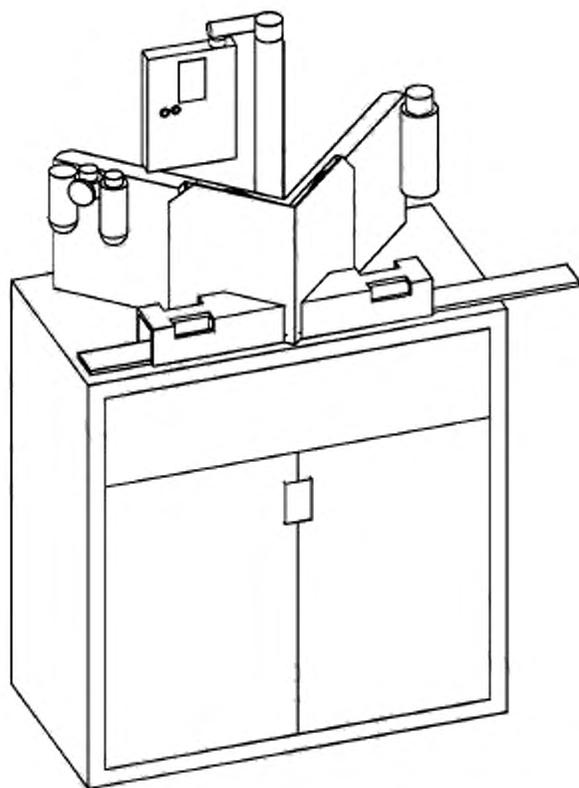
Неподвижные ограждения, ограждающие дисковый отрезной инструмент и передвижные ограждения («туннельные» ограждения, закрывающие разрезаемый материал).
