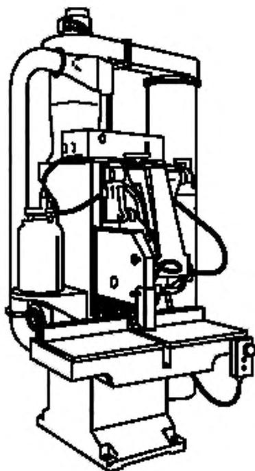
Рисунок С.13 — Круглопильный отрезной станок маятникового типа
