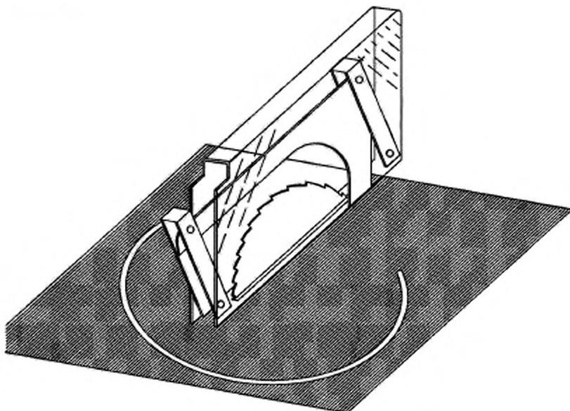
Самозакрывающееся ограждение для отрезного дискового инструмента, приводимое в движение системой тяг, показанное частично открытым (разрезаемый материал не виден).
