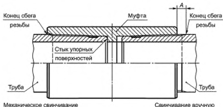
Рисунок 9 — Свинчивание трубы и муфты с резьбовым соединением ОТГГ
