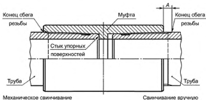
Рисунок 21 — Свинчивание муфты и трубы с резьбовым соединением НКМ
