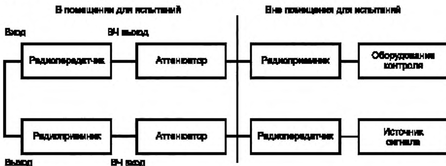
Рисунок 5 — Схема соединений испытуемого приемопередатчика и вспомогательного оборудования при проведении испытаний на помехоустойчивость
