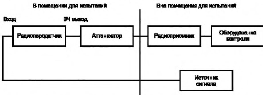
Рисунок 3 — Схема соединений испытуемого радиопередатчика и вспомогательного оборудования при проведении испытаний на помехоустойчивость
