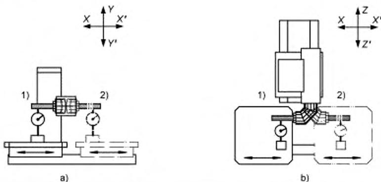
Допуск для а) и б) — 0,025 мм / 300 мм.
