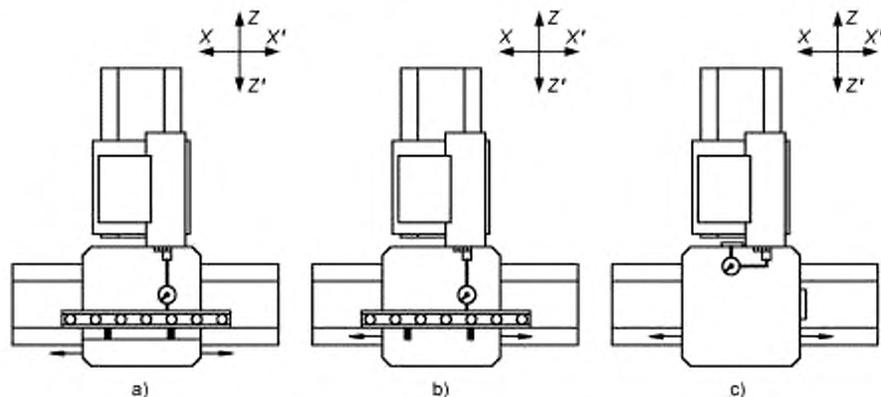
Допуск для а), б) и с) — 0,015 мм / 300 мм
