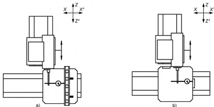
Допуск для а) и б) — 0,015 мм / 300 мм
