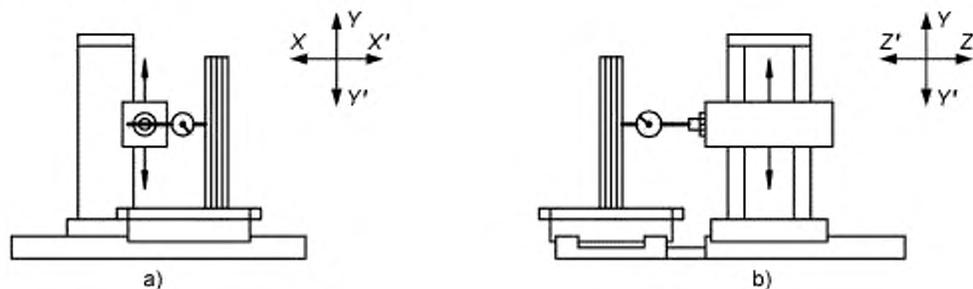
Допуск для a) и b) — 0,015 мм / 300 мм
