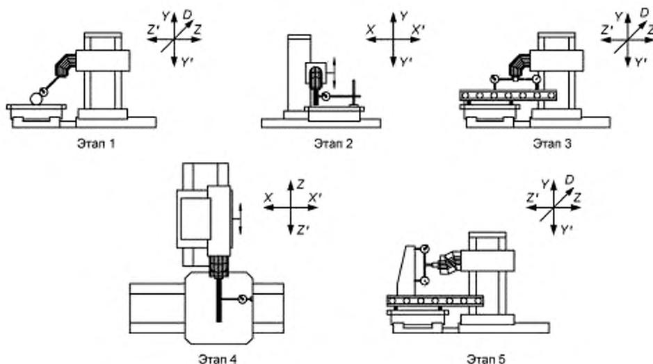
Допуск —  $0,020$  мм /  $300$  мм.
