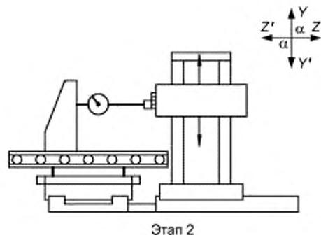
Допуск — 0,02 мм/ 500 мм
