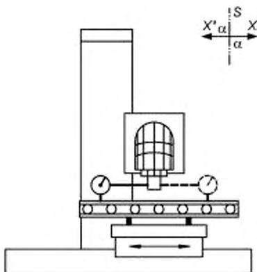
Допуск — 0,025 мм / 300 мм.
