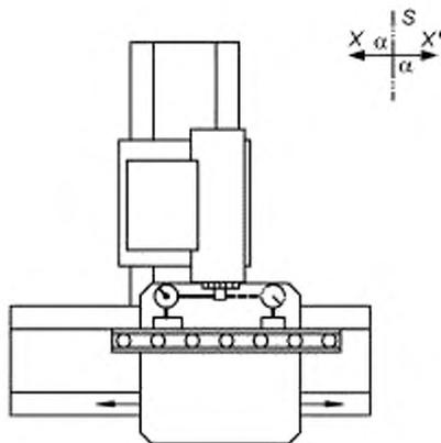
Допуск — 0,015 мм/300 мм (между двумя точками, где производится измерения)
