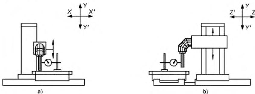
Допуск для а) и б) — 0,025 мм / 300 мм.
