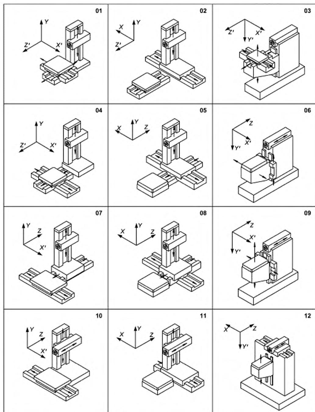
Рисунок 1 — Компоновки обрабатывающих центров с горизонтальным шпинделем
