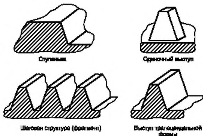
Рисунок 1 — Типовые элементы рельефа рельефной меры
