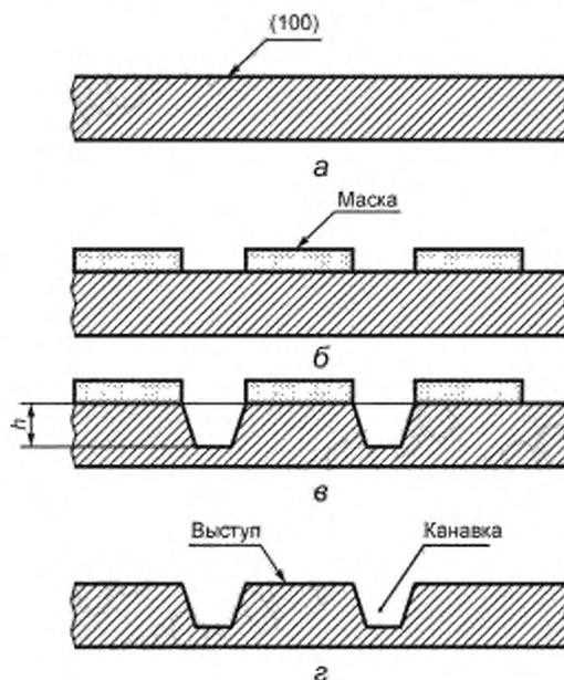
а — исходная пластина монокристаллического кремния с ориентацией поверхности {100}; б — пластина с нанесенной технологической защитой (маской); в — пластина после анизотропного травления,  $h$  — глубина травления; г — пластина после удаления технологической защиты с элементами рельефа
