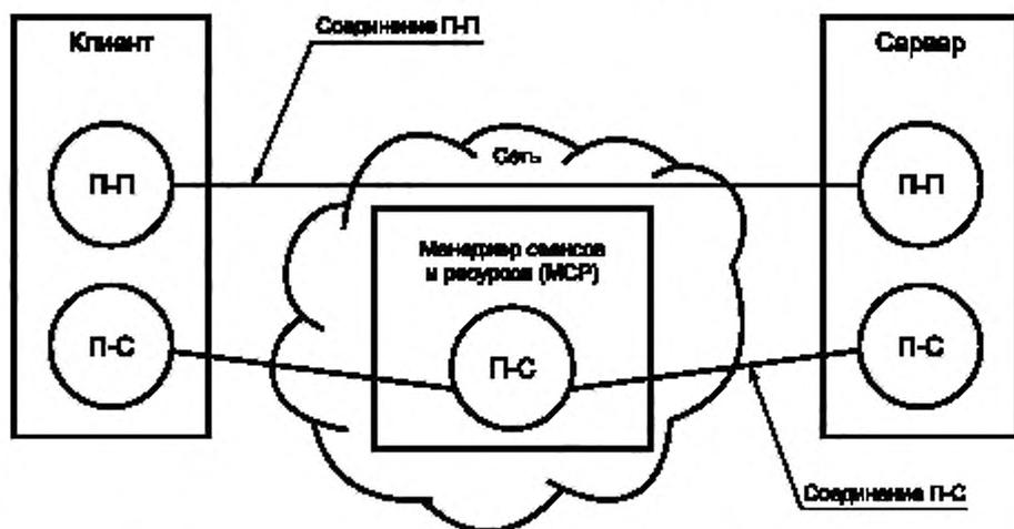
Рисунок 1 — Основная модель Сервер-Сеть-Клиент протокола DSM-CC
