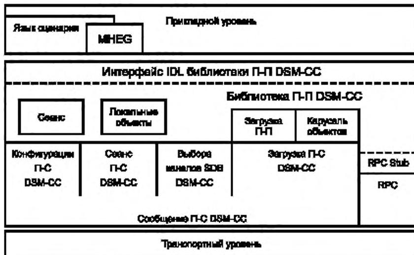
Рисунок 3 — Взаимосвязь протоколов, использующих интерфейсы DSM-CC
