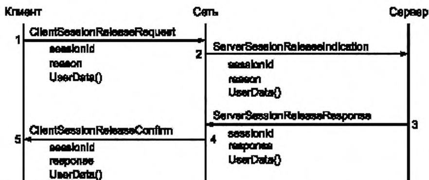
Рисунок Д.7 — Сценарий последовательности выполнения команды разъединения сеанса, инициированной Клиентом
