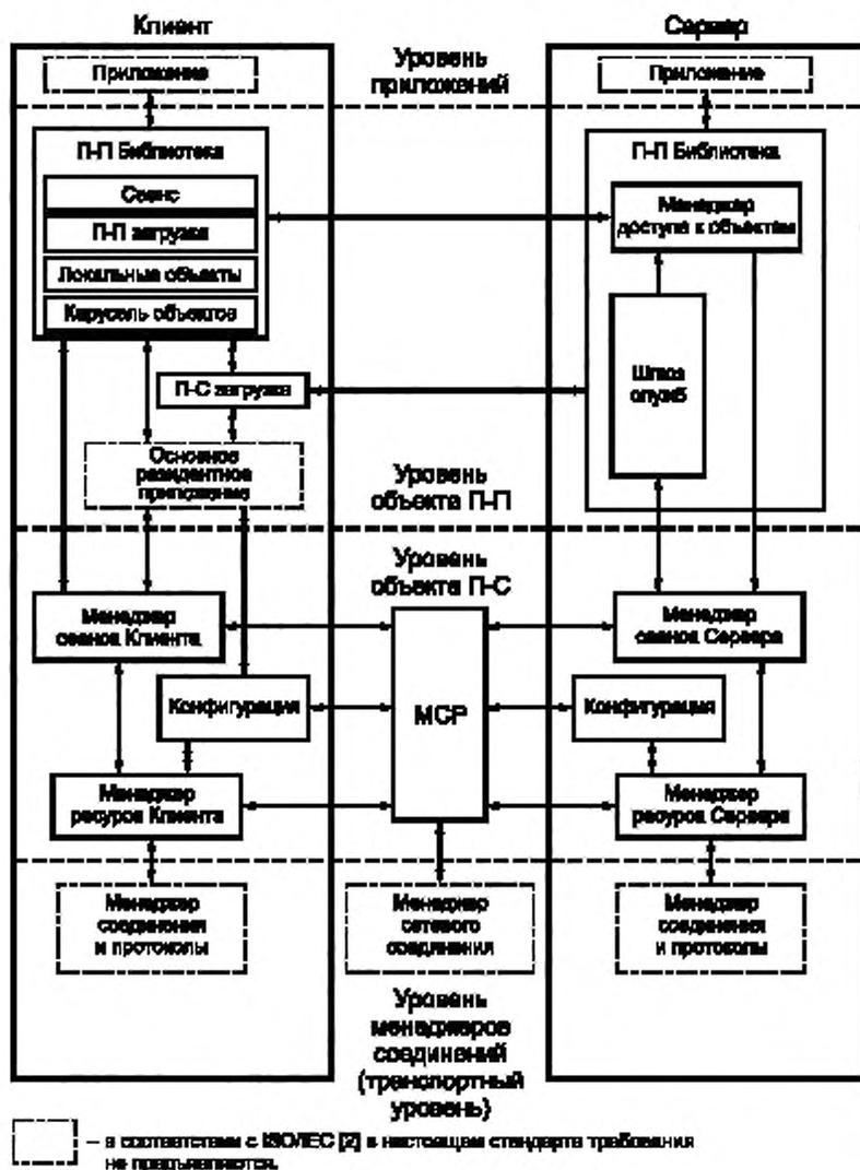
Рисунок 2 — Эталонная модель протокола DSM-CC
