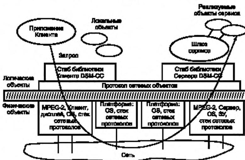
Рисунок Е.1 — Структурная схема, иллюстрирующая среду системы П-П
