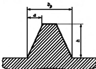
Рисунок 1 — Сечение исследуемого элемента рельефной меры
