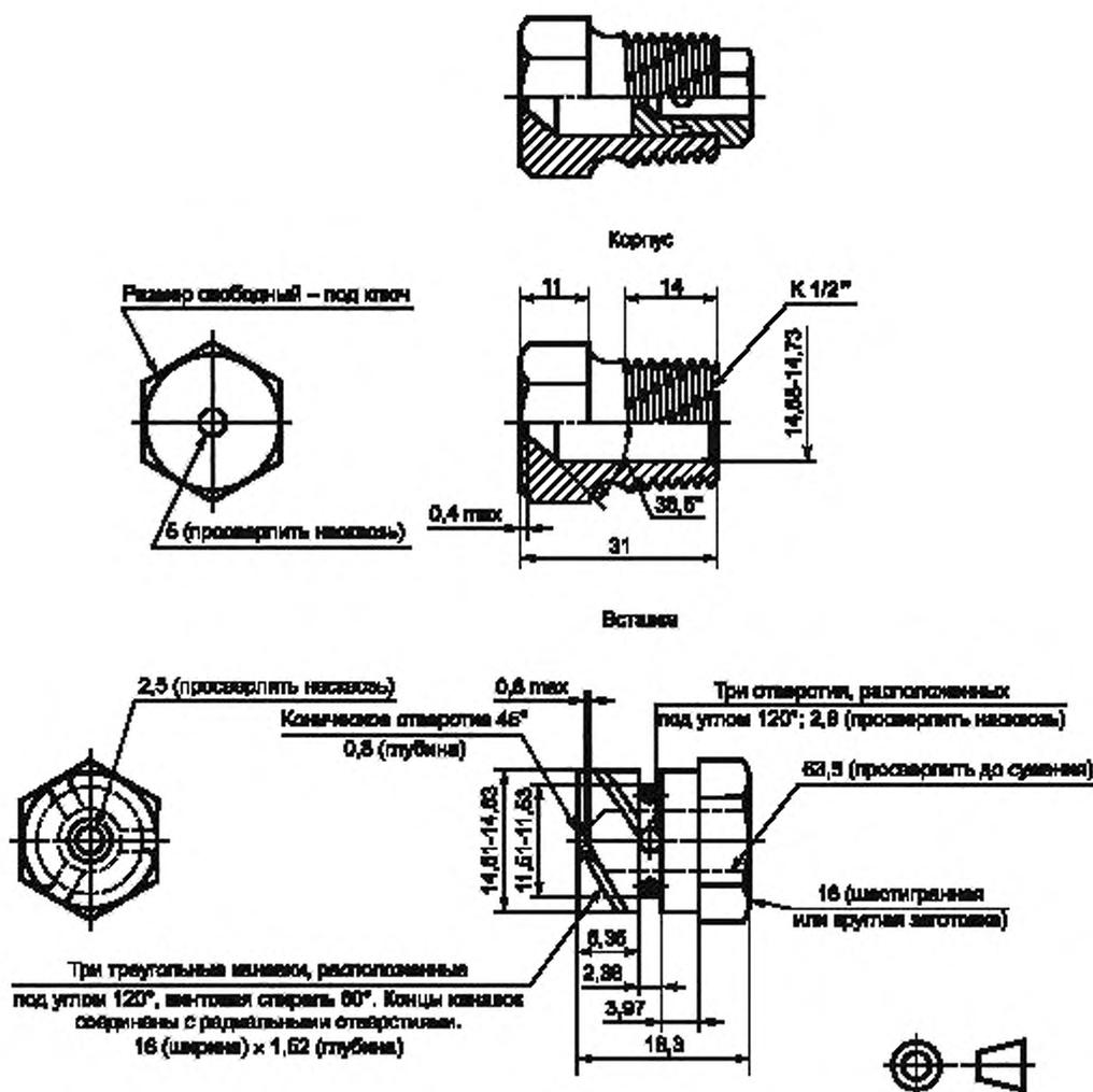
Рисунок В.2 — Распылительная головка
