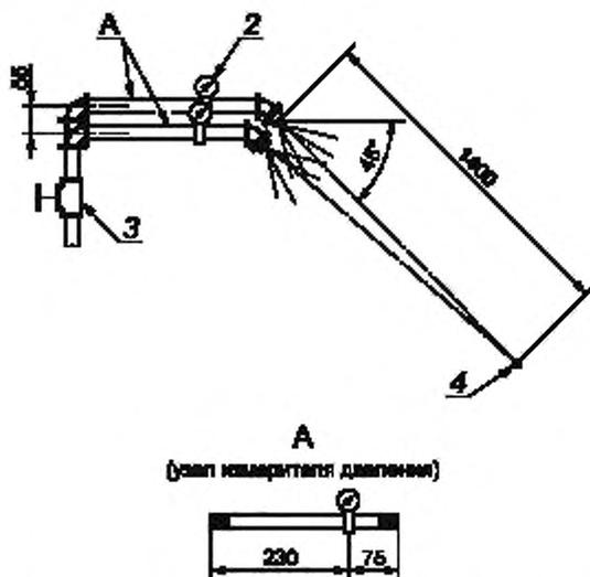
1 — распылительная головка (см. рисунок В.2); 2 — измеритель давления для каждой распылительной головки в отдельности;
