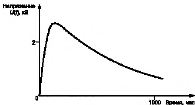
Рисунок S.1 — Форма сигнала при отсутствии ограничителей перенапряжений и пробоя изоляции
