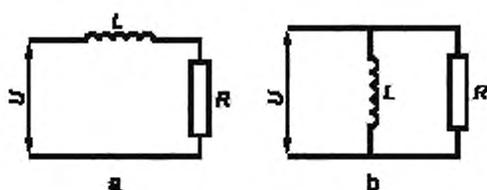
Рисунок М.2 — Эталонная активно-индуктивная нагрузка:
