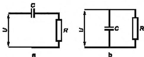
Рисунок М.3 — Эталонная активно-емкостная нагрузка:
