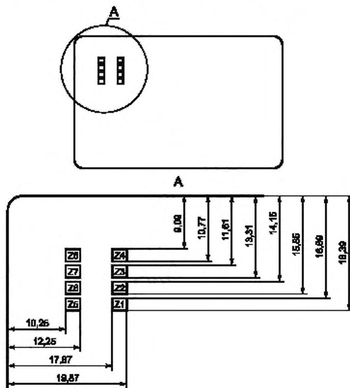
Рисунок В.1 — Расположение возможных проводящих зон
