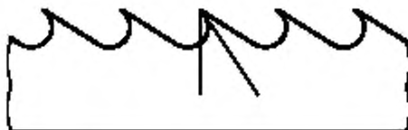
Рисунок 8 — Форма с положительным передним углом
