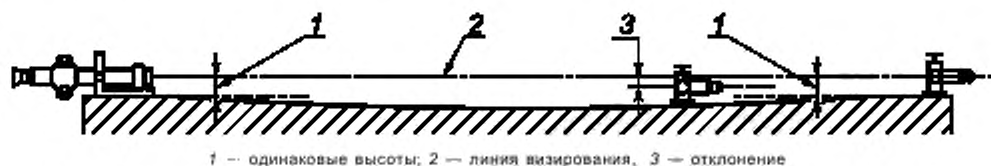
Рисунок А.19 — Контроль прямолинейности с применением измерительной визирной трубы
