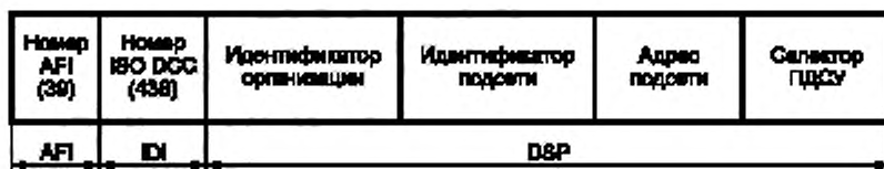
Рисунок 15 — Формат сетевого адреса КДС ИСО (ISO DCC)
