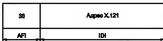
Рисунок 16 — Пример формата сетевого-адреса X.121
