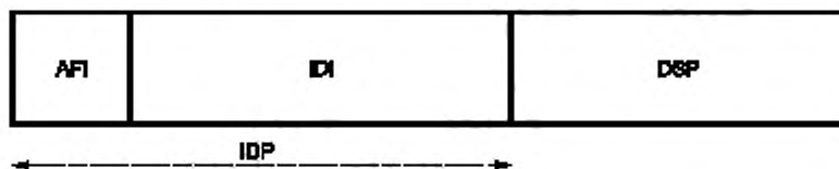
Рисунок 14 — Структура сетевого адреса
