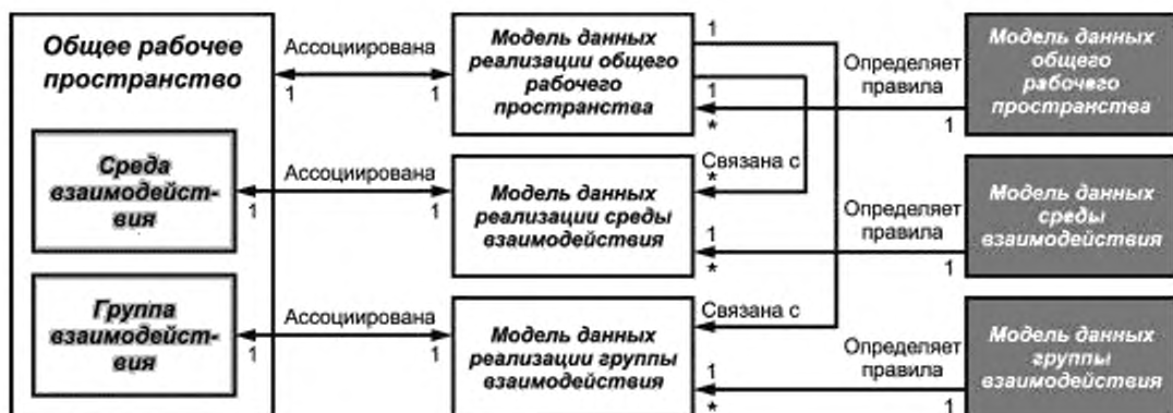
Рисунок 2 — Отношения между общим рабочим пространством, общей средой и группой взаимодействия, совместной реализацией модели данных и техническими характеристиками моделей данных в соответствии с серией стандартов ИСО/МЭК 19778
