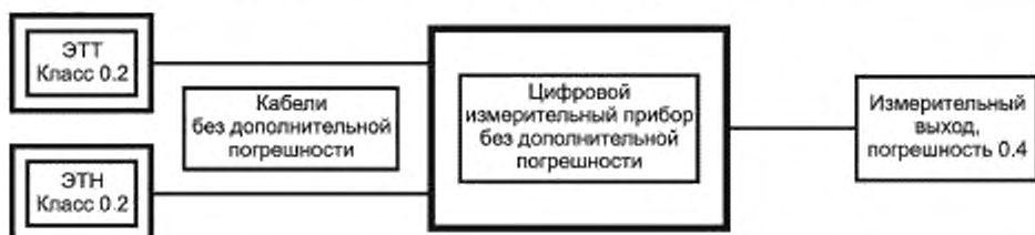
Рисунок В.6 — Сравнение погрешностей в традиционной системе измерения и основанной на ЭТТ и ЭТН с цифровым выходом
