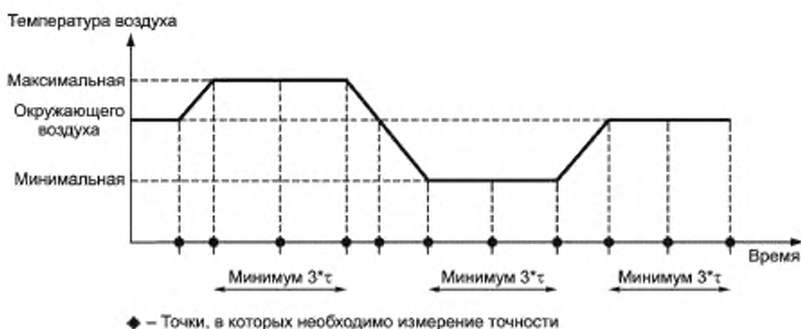
Рисунок 16 — Температурные циклы для проверки класса точности
