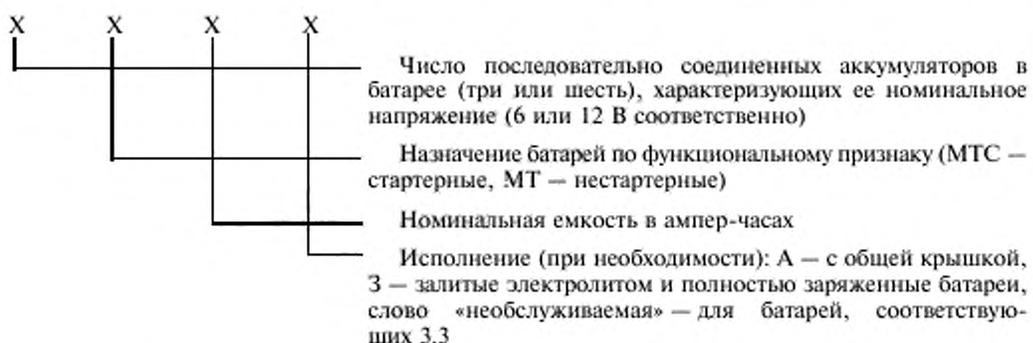
Пример условного обозначения батарей, состоящих из шести аккумуляторов, номинальным напряжением 12 В, стартерных, номинальной емкостью 18 А·ч, с общей крышкой, предназначенных для потребностей экономики страны:
