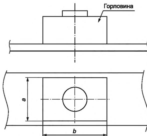
Рисунок Н.1 — Схема измерения параметров прямоугольной горловины
