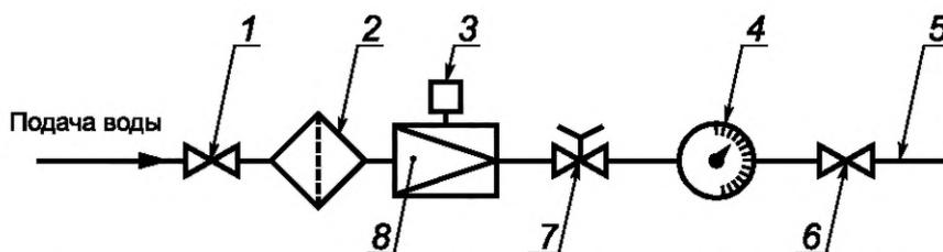
1, 6 — вентили; 2 — фильтр; 3 — указатель расхода; 4 — счетчик жидкости; 5 — сливной трубопровод;
