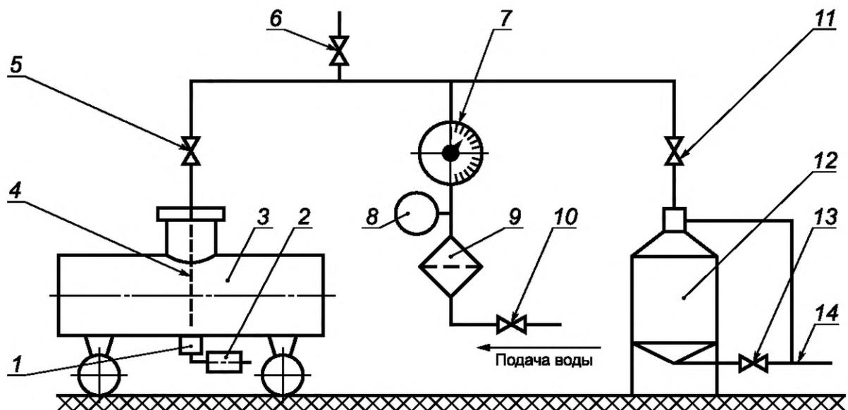
1 — нижний (донный) клапан; 2 — гидросистема слива; 3 — ТМ; 4 — шланг; 5, 6, 11, 13 — краны; 7 — счетчик жидкости;
