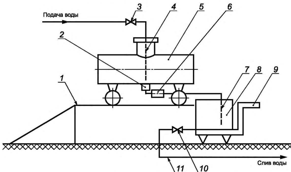
1 — эстакада; 2 — нижний (донный) клапан; 3 — наливной кран; 4 — шланг; 5 — ТМ; 6 — гидросистема слива; 7 — сливной шланг; 8 — вспомогательная тара; 9 — весы; 10 — сливной кран; 11 — сливной трубопровод
