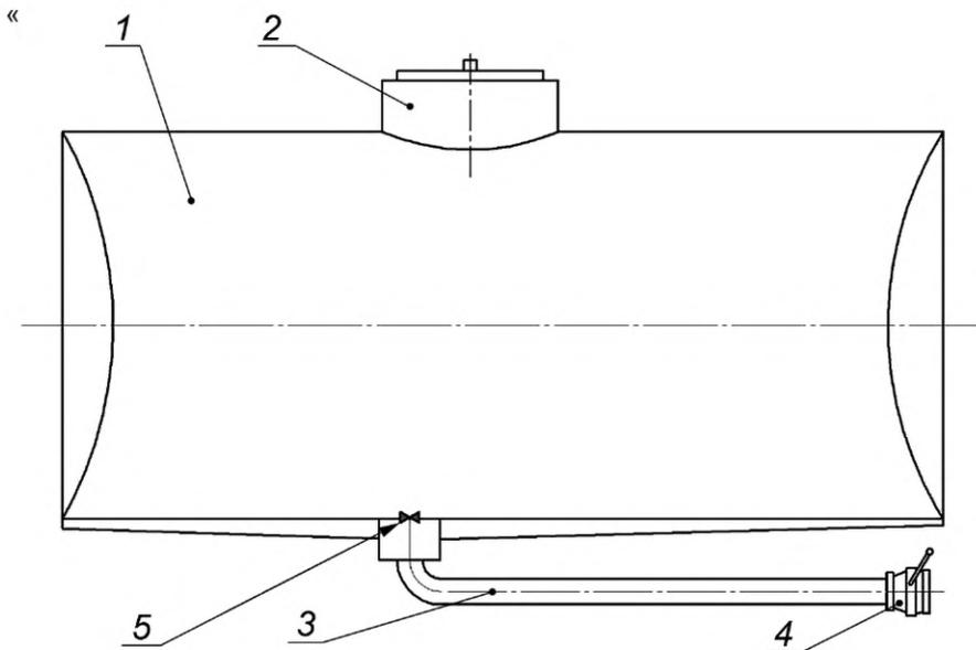
1 — котел цистерны ТМ; 2 — горловина; 3 — трубопровод системы нижнего налива; 4 — клапан (API адаптер) системы; 5 — донный клапан
