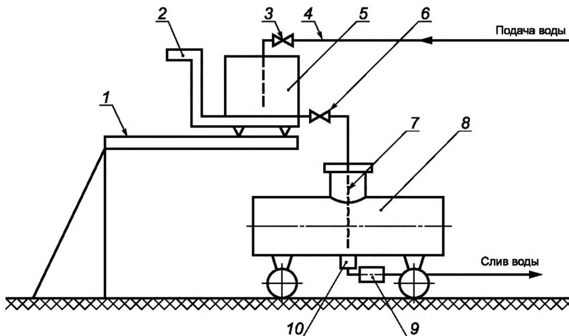
1 — эстакада; 2 — весы; 3 — наливной кран; 4 — наливной трубопровод; 5 — вспомогательная тара; 6 — сливной кран; 7 — сливной шланг; 8 — ТМ; 9 — гидросистема слива; 10 — нижний (донный) клапан
