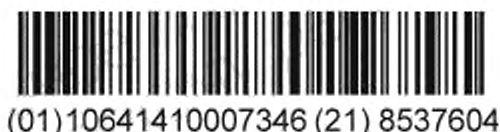
Рисунок 11 — Частичная резервная копия номера SGTIN радиочастотной метки в символе штрихового кода с использованием идентификаторов AI (01) и AI (21)
