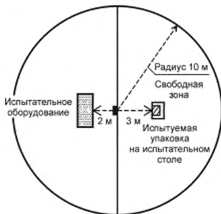
Рисунок С.1 — Номинальная схема размещения оборудования для испытаний транспортируемой единицы
