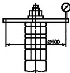
Рисунок 103 — Испытание на биение дистанционных колец шпинделя
