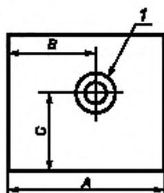
1 — отверстие стола; A — длина стола, B — расстояние от края стола до центра отверстия стола;
