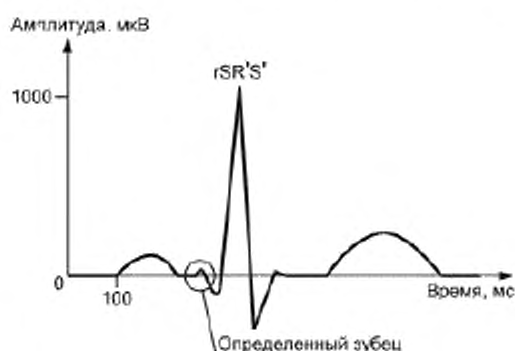
Рисунок GG.4 – Комплекс QRS с определенным зубцом R малой амплитуды (см. рисунок GG.7)
