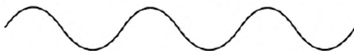
ПОМЕХА в виде синусоидальных колебаний базовой линии с частотой 0,3 Гц и амплитудой 0,5 мВ
