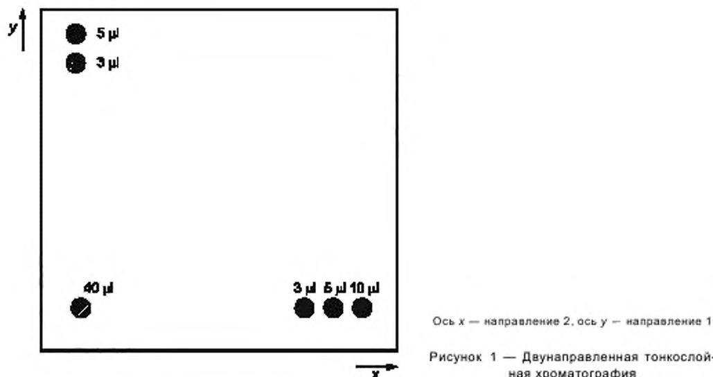
Нагревают сухую пластину в сушильном шкафу (термостате) (см. 6.18) при температуре 50 °С в течение 5 мин. Охлаждают пластинку и помещают ее в другую камеру для тонкослойной хроматографии для элюирования в направлении 2. Хроматографируют (элюируют) пластинку во втором направлении до тех пор, пока фронт растворителя не достигнет высоты около 7 см.
