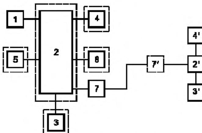
1 — извещатель; 2, 2 — установка управления; 2 — охранный (охранно-пожарный) приемно-контрольный прибор, 2' — пульт централизованного наблюдения; 3, 3' — источник электропитания; 4, 4' — световой и/или звуковой оповещатель; 5 — устройство, управляемое установкой управления; 6 — программируемое входное устройство; 6 — шифрующее устройство; 7, 7' — сигнальный интерфейс; модем; 7, 7' — система передачи извещений
