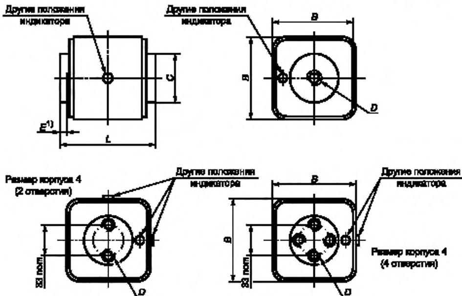
¹) Минимальное расстояние между монтажной поверхностью и конструктивными элементами плавкого предохранителя
