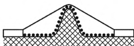
Рисунок F.3 — V-образная канавка
