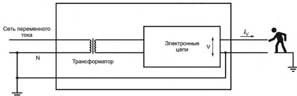
Рисунок W.2 — Ток от прикосновения от заземленной цепи
