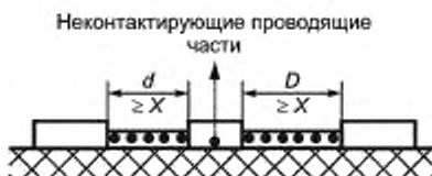
Рисунок F.12 — Измерения через отверстия в кожухе
