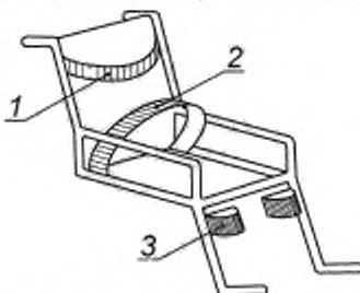
1 — передний фиксатор туловища; 2 — передний фиксатор таза; 3 — передний фиксатор нижней части ноги
