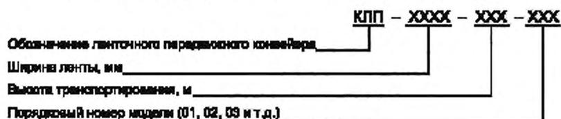
Пример условного обозначения ленточного передвижного конвейера с шириной ленты 500 мм, высотой транспортирования 4,5 м, третьей модели:
