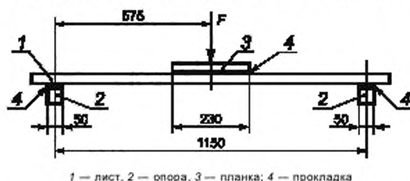
Рисунок 21 — Схема испытания на изгиб целых листов
