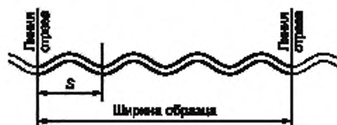
Рисунок 19 — Схема обрезки целых листов перед испытанием
