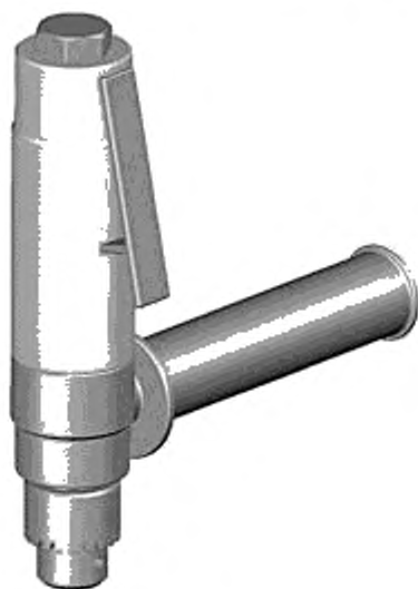
Рисунок 2 — Прямая сверлильная машина с поддерживающей рукояткой
