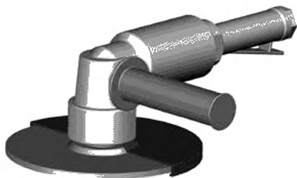
Рисунок 4 — Пневматическая угловая шлифовальная машина с обособленной основной рукояткой
