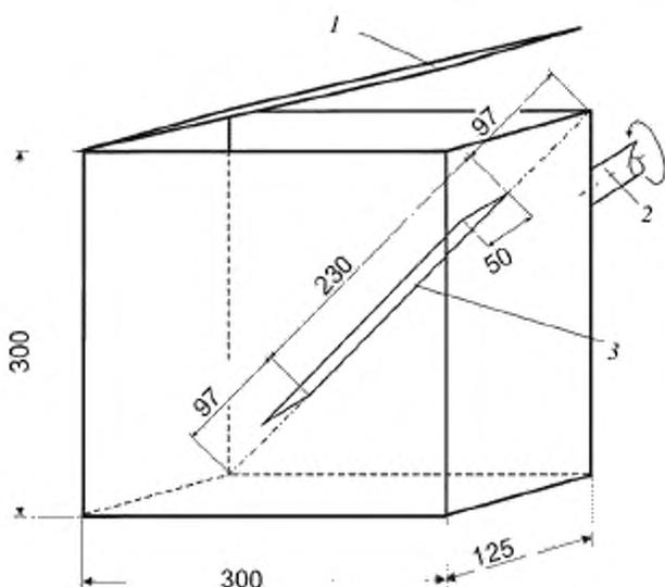
1 – дверь для заполнения; 2 – приводной вал; 3 – перегородка (дроссель)
