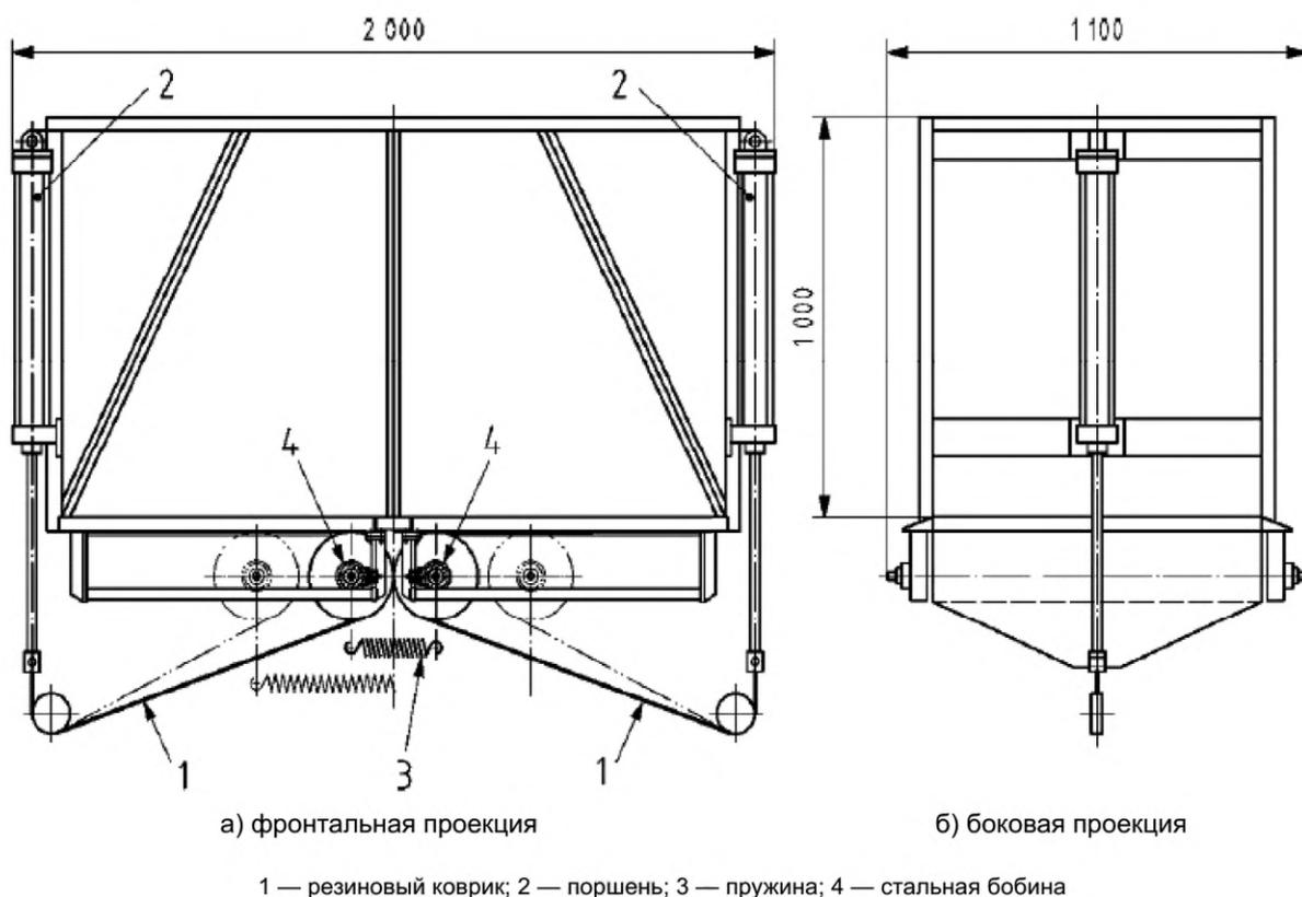
Рисунок 1 — Аппарат для определения степени сводообразования неслипающегося материала
