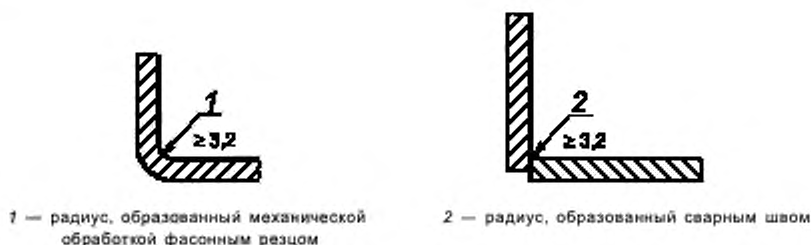
Рисунок А.2 — Углы и радиусы закругления в пищевой зоне
