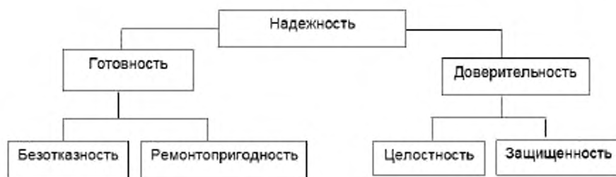
Рисунок 2 — Составляющие свойства надежности
