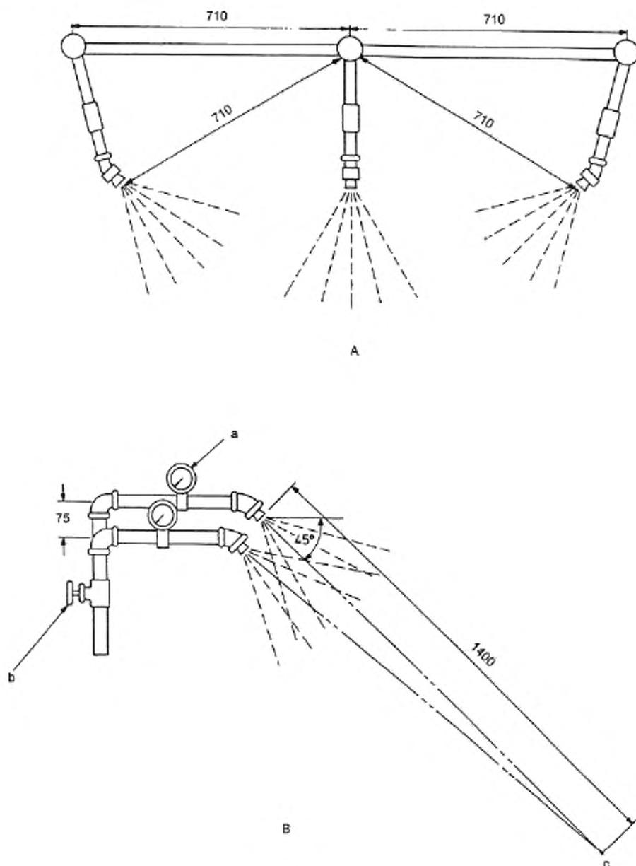
*a* – манометр для каждой распылительной головки; *b* – регулировочный клапан для каждой распылительной головки; *c* – фокус
