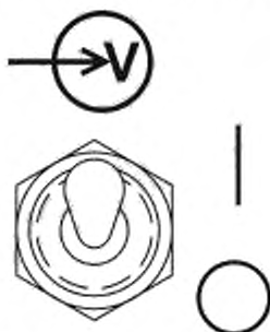
Рисунок L.1 — Силовой переключатель входного напряжения
