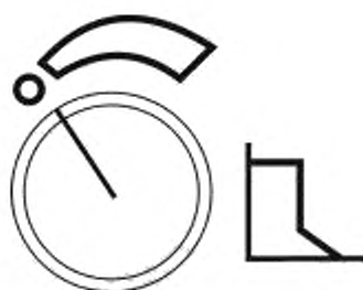
Рисунок L.2 — Потенциометр для регулировки мощности дуги
