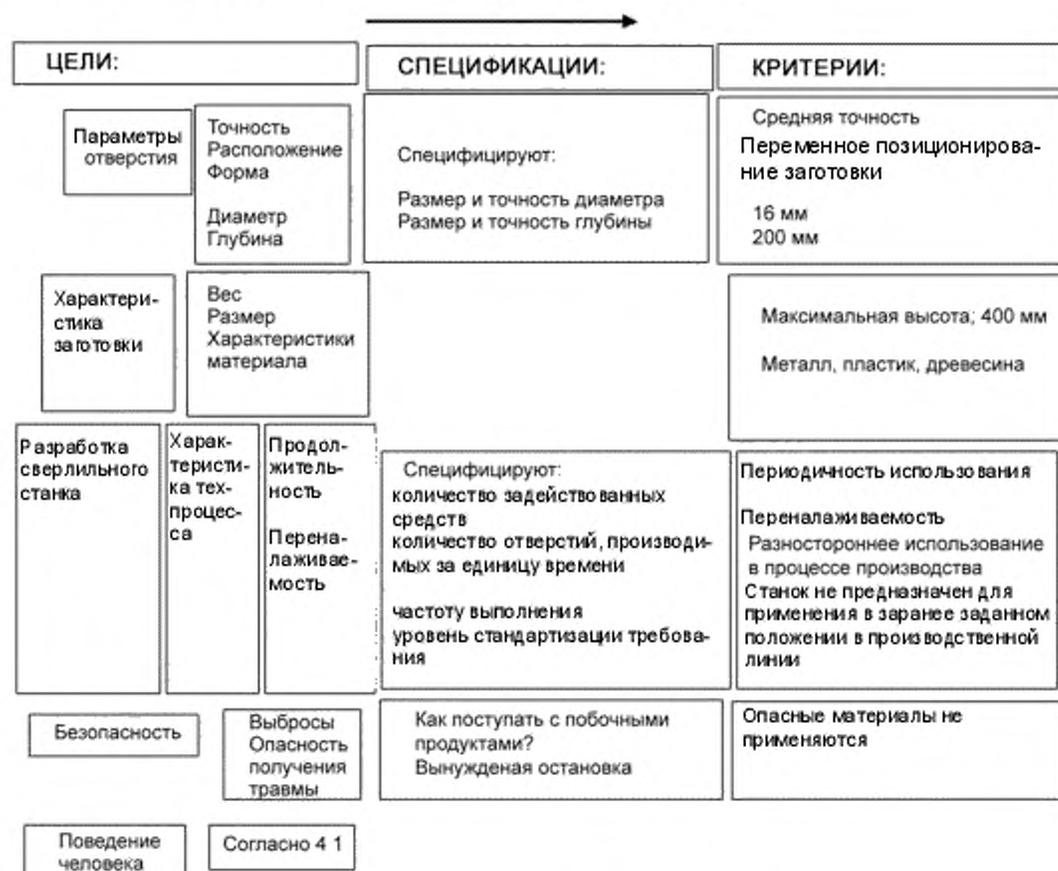
Рисунок В.2 – Пример общих целей разработки
