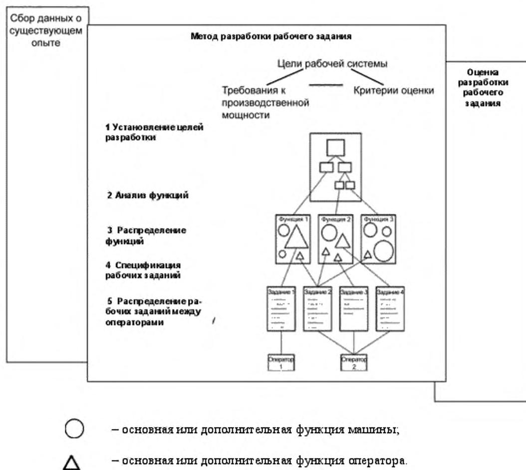
Рисунок 1 – Схема процесса разработки рабочего задания
