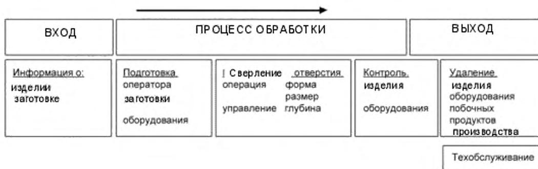
Рисунок В.3 – Блок-схема процесса в общем случае
