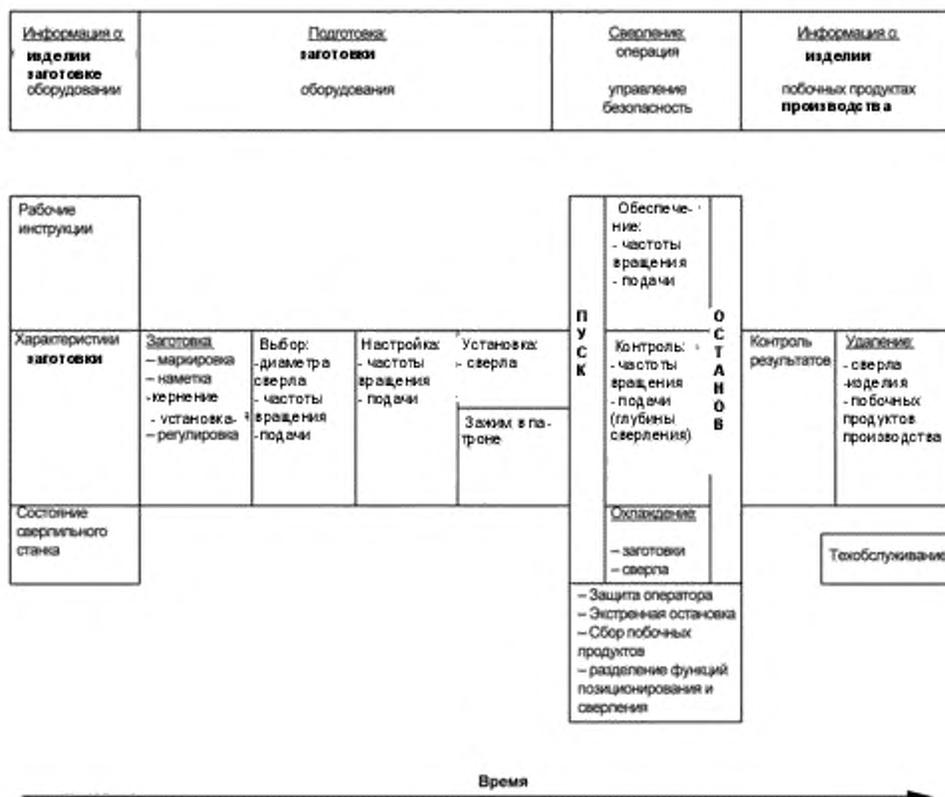
Рисунок В.5 – Иерархическая блок-схема специфицированных функций
