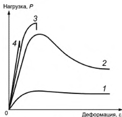
Рисунок Б.1 — Диаграммы «нагрузка — деформация» для льда, испытываемого при различных постоянных скоростях деформации: \dot{\epsilon}_1 < \dot{\epsilon}_2 < \dot{\epsilon}_3 < \dot{\epsilon}_4
