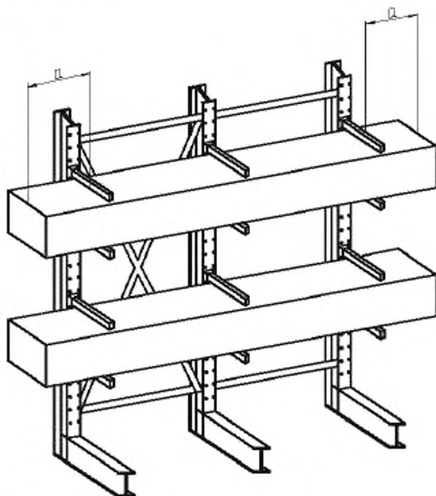
Рисунок 11 – Размещение грузов на консольных стеллажах
