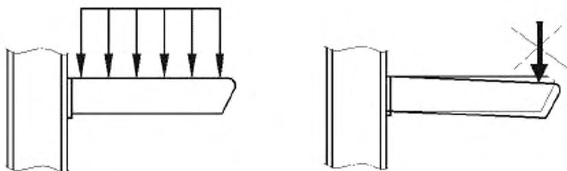
Рисунок 12 – Равномерное распределение нагрузки по длине консоли
