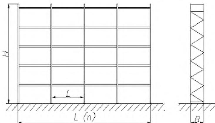
H – высота рамы стеллажа, L – ширина секции, L(n) – длина ряда стеллажа, B – ширина рамы стеллажа
