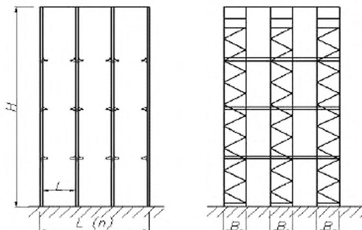
$H$  – высота рамы стеллажа,  $L$  – ширина канала,  $L(n)$  – ширина блока,  $B$  – ширина рамы стеллажа
