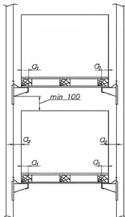
Рисунок 8 – Размещение груза относительно опорных профилей (грузонесущих направляющих)
