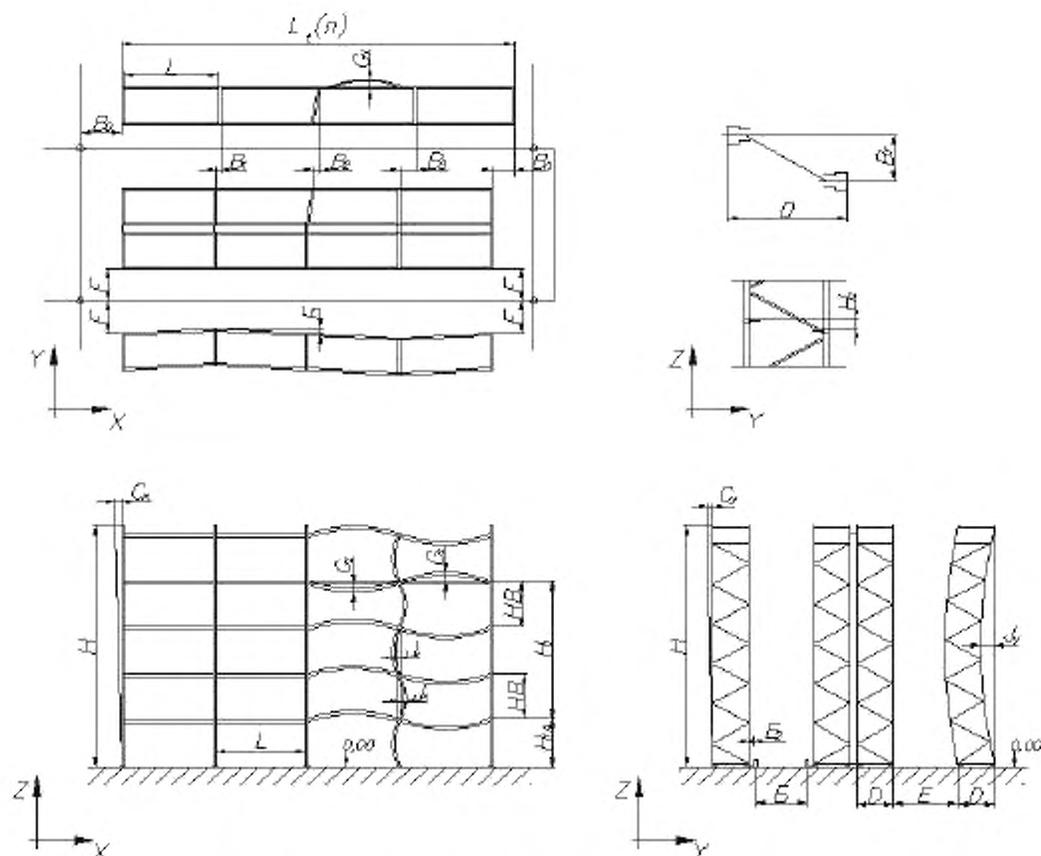
Рисунок 7 – Параметры, подлежащие контролю в ненагруженном состоянии системы
