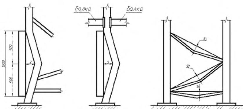
Рисунок Б.1 – Максимально допустимые значения деформации элементов
