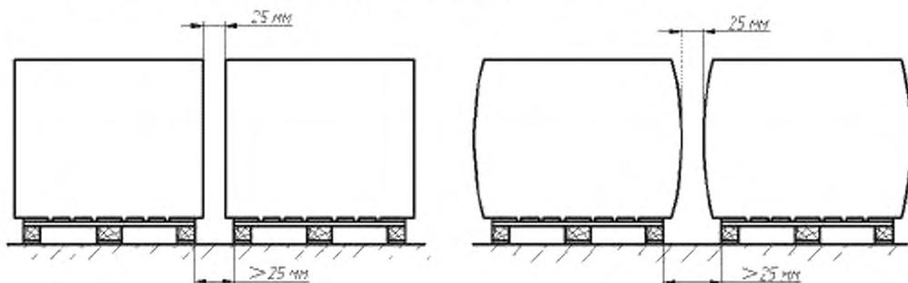
Рисунок 9 – Размещение груза в глубину канала
