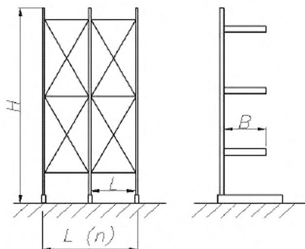
$H$  – высота рамы стеллажа,  $L$  – ширина секции,  $L(n)$  – ширина блока стеллажа,  $B$  – длина консоли
