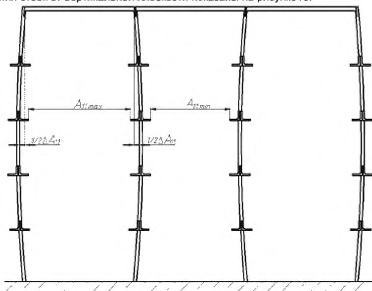
Рисунок 10 – Отклонение стоек от вертикальной плоскости внутри канала
