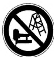
Цветовое исполнение: красный на белом фоне, машина и лестница черные Рисунок D.1 – Символ «Не использовать на строительных лесах, лестницах»
